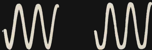
Fig. 1 - Tracce oscilloscopiche ad 800 Hz di un'onda avente una distorsione dello 0,1% - a sinistra - e superiore al 10% - a destra
